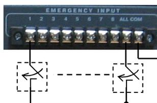
При замыкании клеммы 1-8, и клеммы COM включаются соответствующие **группы** усилителей RA-8236 (см. инструкцию к RA-8236), индикаторы CH1-CH8 (поз.4) загораются красным цветом. Сигнал со входа EM1 поступает на выход блока OUT ( поз. 16) и на выход усилителя RA-8236 который запрограммирован в соответствующую группу. При этом основной регулятор громкости VOLUME (поз.8) блокируется, регулировка громкости становится возможной только при помощи регулятора EM1 (поз.17).
