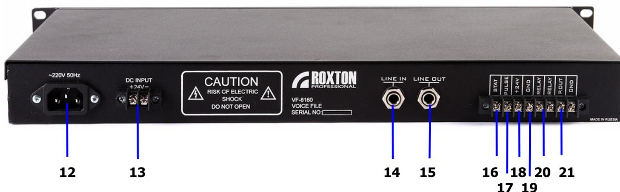
**12. Разъем 220V/50HZ:** Разъем для подключения питающего напряжения 220В 50 Гц. Питающее напряжение подается через кнопку POWER (позиция 11).
